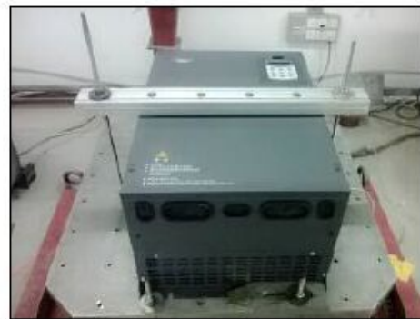
图21 机械冲击试验±X轴向样品架设
