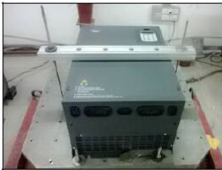
图18 机械冲击试验±Y轴向样品架设
